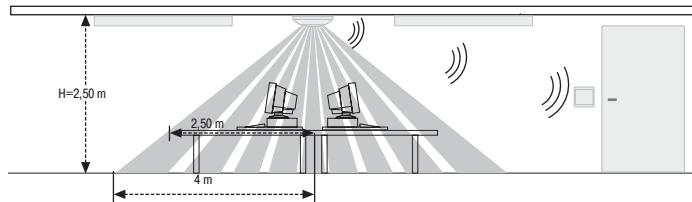
**⚠** Не устанавливайте радио-датчик присутствия HM в непосредственной близости от светильников и вентиляторов. Используйте только щелочные батареи, так как только этот тип имеет достаточную емкость для импульсного тока. Следите указаниям по проектированию Радио-шины!
