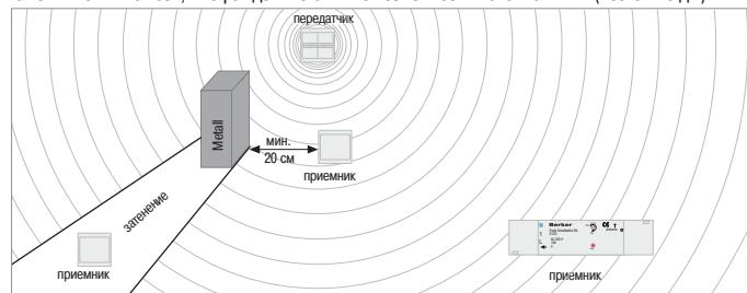
■ Не рекомендуется устанавливать передатчики и приемники за металлическими или токопроводящими поверхностями, например, антистатическими полами, металлическими покрытиями, кабельными линиями, металлической сеткой, панели содержащие углеволокно, нагревательные котлы, системы теплого пола и т.д.
