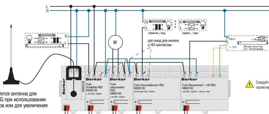
Дополнительно требуется антенна для радиоприемников REG при использовании металлических шкафов или для увеличения радиуса действия.
